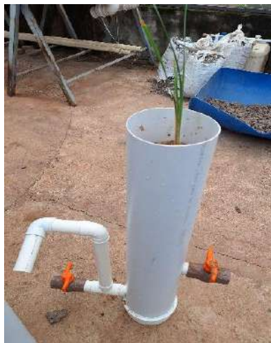
Figura 2. Construcción de humedal vertical de fondo saturado.
