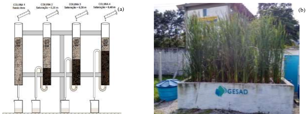
Figura 1(a) Columnas de vidrio en escala de laboratorio. (b) HCV-FS en escala piloto de campo.
