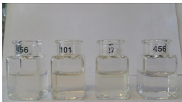
**Figura 2.** Color en muestras de agua expuestas a A) bagazo de agave, B) Aserrín y C) Mazorca de maíz después de tres días. D) Agua destilada.
